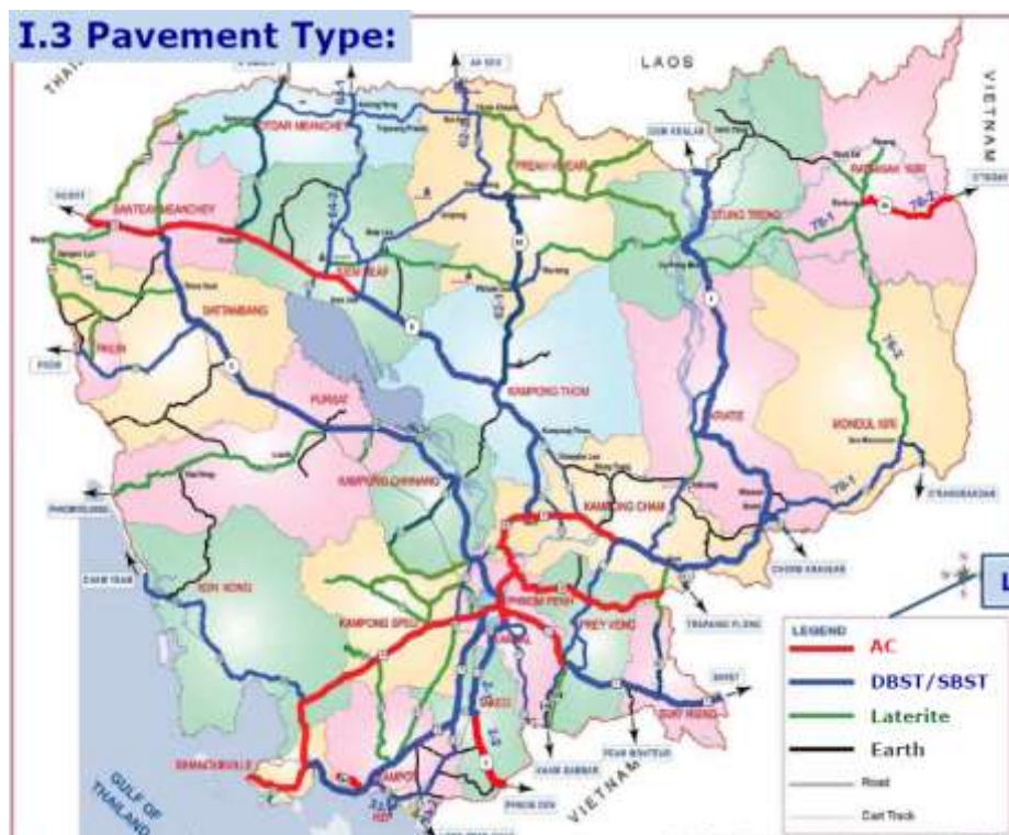
ตารางที่ 1 แสดงประเภทและสถานะการพัฒนาถนนในประเทศกัมพูชาแบ่งตามระบบหมายเลขทางหลวง
