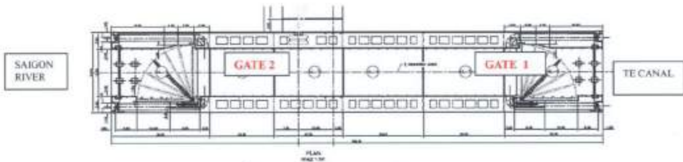
รูปที่ 4.4.1-1 การใช้งานประตูเรือสัญจร
